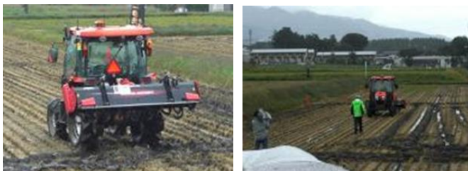
図. トラクターの自動運転デモの例(長野県伊那市) 人が乗らない状態での完全自動走行が可能。 ロータリー耕うんや代掻きを行う。 http://www.inacity.jp/shisei/inashiseisakusesaku/shinsangyougijutu/smartnougyou/smartnougyou.html
